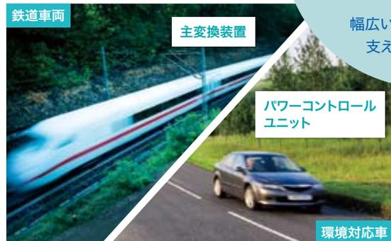
ハイブリッド車、電気自動車のモータ駆動を制御する「パワーコントロールユニット」内にIGBTが搭載されています。また鉄道車両においても、安定した走行や運転制御のための主変換装置にIGBTが使用されています。
