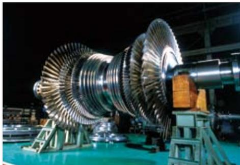
地熱発電用のタービンには、地熱蒸気を含む腐食成分に耐え得る適切な材料を使用しています。
