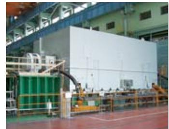
世界最大容量クラスの空気冷却タービン発電機
