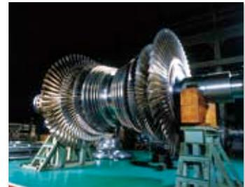
高効率の反動式蒸気タービン
