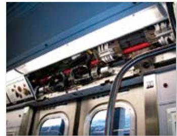
ニューヨーク地下鉄向けリニアモータ駆動ドアシステム
