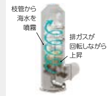
スクラバ内部構造
