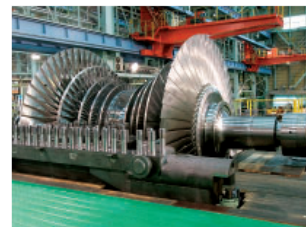
川崎工場・蒸気タービンロータ
