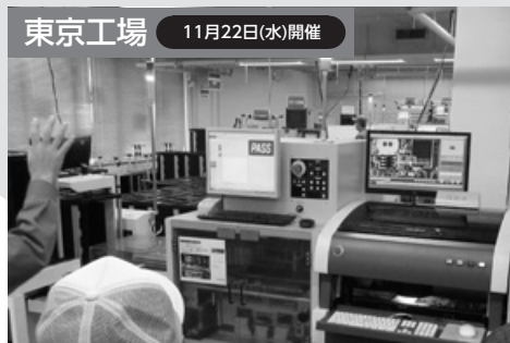
▲計測・制御機器等に組み込まれるプリント基板の実装工程
