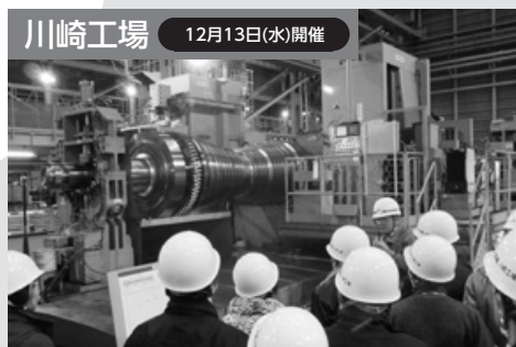
▲火力・地熱発電用タービンの加工工程
