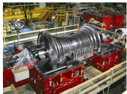
蒸気タービン
