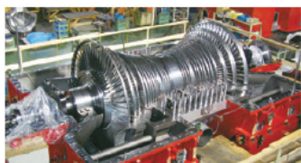
蒸気タービン
