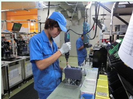
サーボアンプの組立作業
