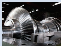
蒸気タービン
