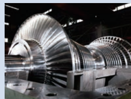
蒸気タービン
