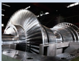
蒸気タービン
