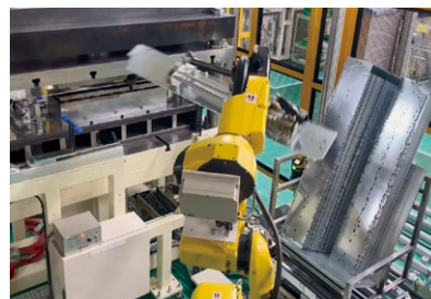
缶自販機 板金部品の自動化ライン(三重工場)
