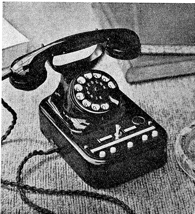
第一圖「ライハ」電話機 前列白鈕は内部呼出鈕、その後の電鍵は切替及聴話用、その右は話中表示器
