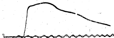
40 KV Chopped wave 破壊ニヨリ既ニ 電壓上昇セズ電流ノ増加ヲ示シテ居ル
