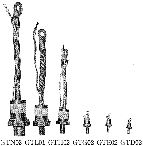
第2図 中容量サイリスタ系列 Fig.2. Middle power thyristor series
