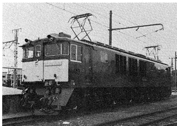
第9図 EF 64形直流電気機関車 Fig. 9. EF 64 type DC electric locomotive
