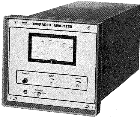
第5図 シングルビーム方式非分散赤外線ガス分析計 Fig. 5. Single beam method NDIR gas analyzer
