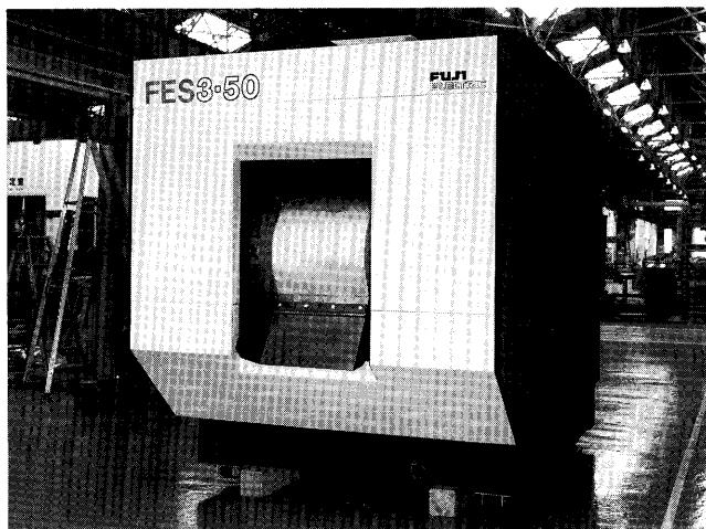
図20 小規模用電気浸透式ベルトプレス
