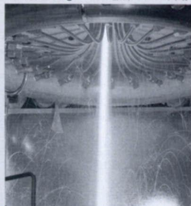
溶解容量50kgのCCLM底部からの出湯
