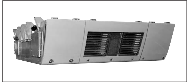
図12 主変換装置の外観
