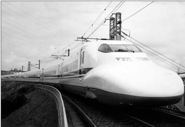
図11 新幹線 700 系先行試作車の外観
