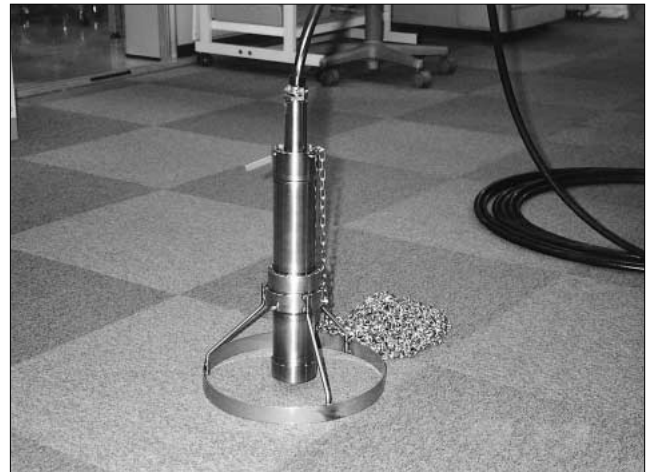
図17 下水対応の光ファイバ式投込み水位計
