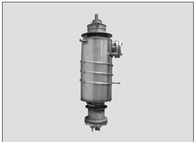
図 18 1kW 級固体高分子形燃料電池用改質器/CO 変成器の外観
