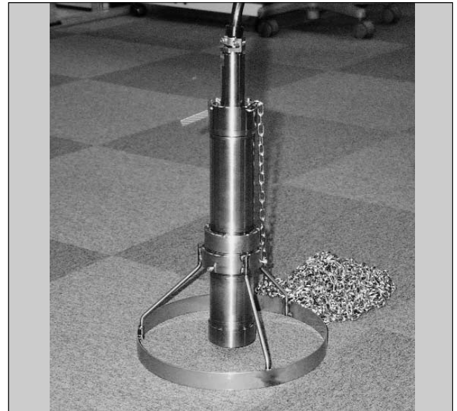
図6 光水位計の外観
