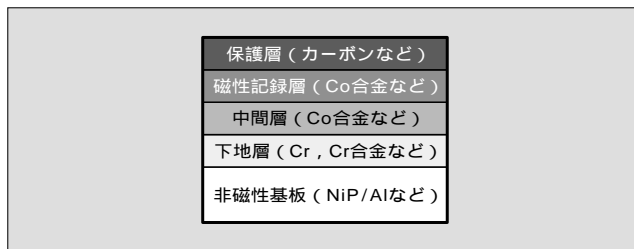
図1 磁気記録媒体の基本層構成
