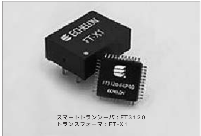
図 5 スマートトランシーバとトランスの外観
