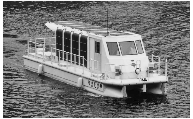
図3 電動船「ひだまり」太陽光発電設備
