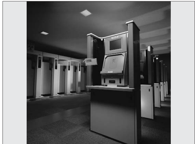
図 25 無線通信式入退域管理ゲートと線量計
