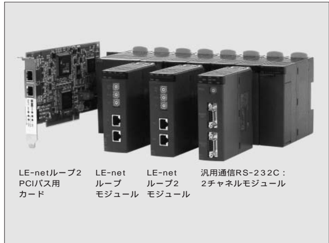
図1 新規通信モジュールとカード(4形式)
