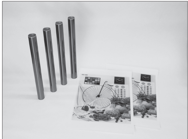
図4 高画質プリンタ用有機感光体とその出力画像
