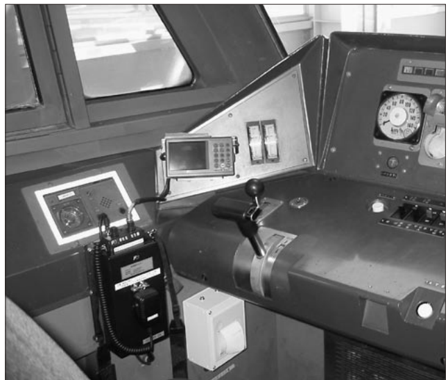
図2 列車に搭載した車載無線装置
