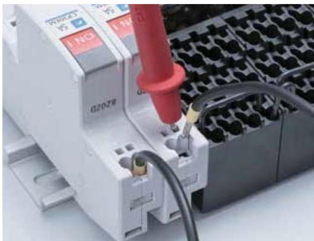
導通チェッカーを強く挿しすぎると配線が抜けますのでご注意ください。
