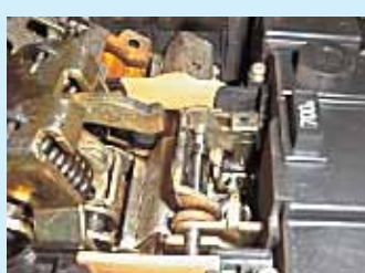
長期使用により機構部のグリスが枯渇
