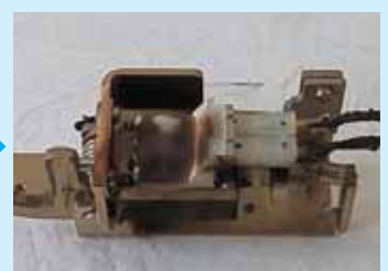
内部コイル焼損、コンタクタの機能停止
