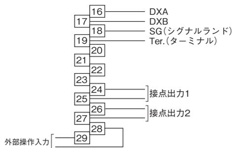
注) RS-485、Modbus RTU仕様は、17番(-)と19番(Ter.)を短絡することで、内部に終端抵抗が接続されます。
