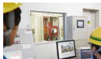
事故を想定した大電流を通電し、安全性を検証する遮断試験
