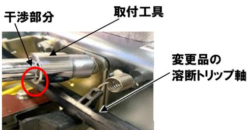
※現行品のAL-3Cを変更後のLBSに取付ようとするとき、溶断トリップ軸と工具が干渉します。工具もボルト頭に斜めに入る為、規定トルクでスムーズな締め付けが出来ない場合があります。
