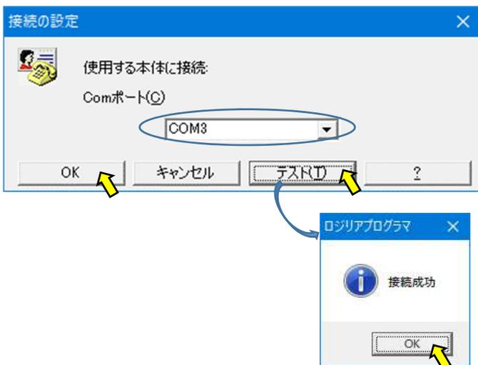
[接続の設定]ウィンドウで2項のデバイスマネージャーで確認したポート番号を「Com ポート」へ設定します。
