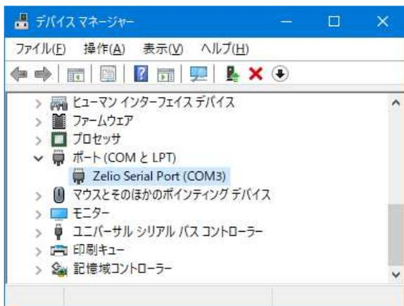
Windows のデバイスマネージャーを開き、USB インタフェースケーブルが認識されていることを確認します。
