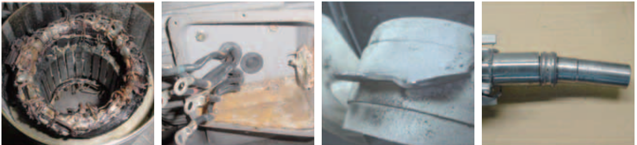
コイル部の焼損 Coil burnout
