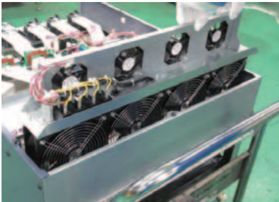
冷却ファンの交換 Replacing the cooling fan
