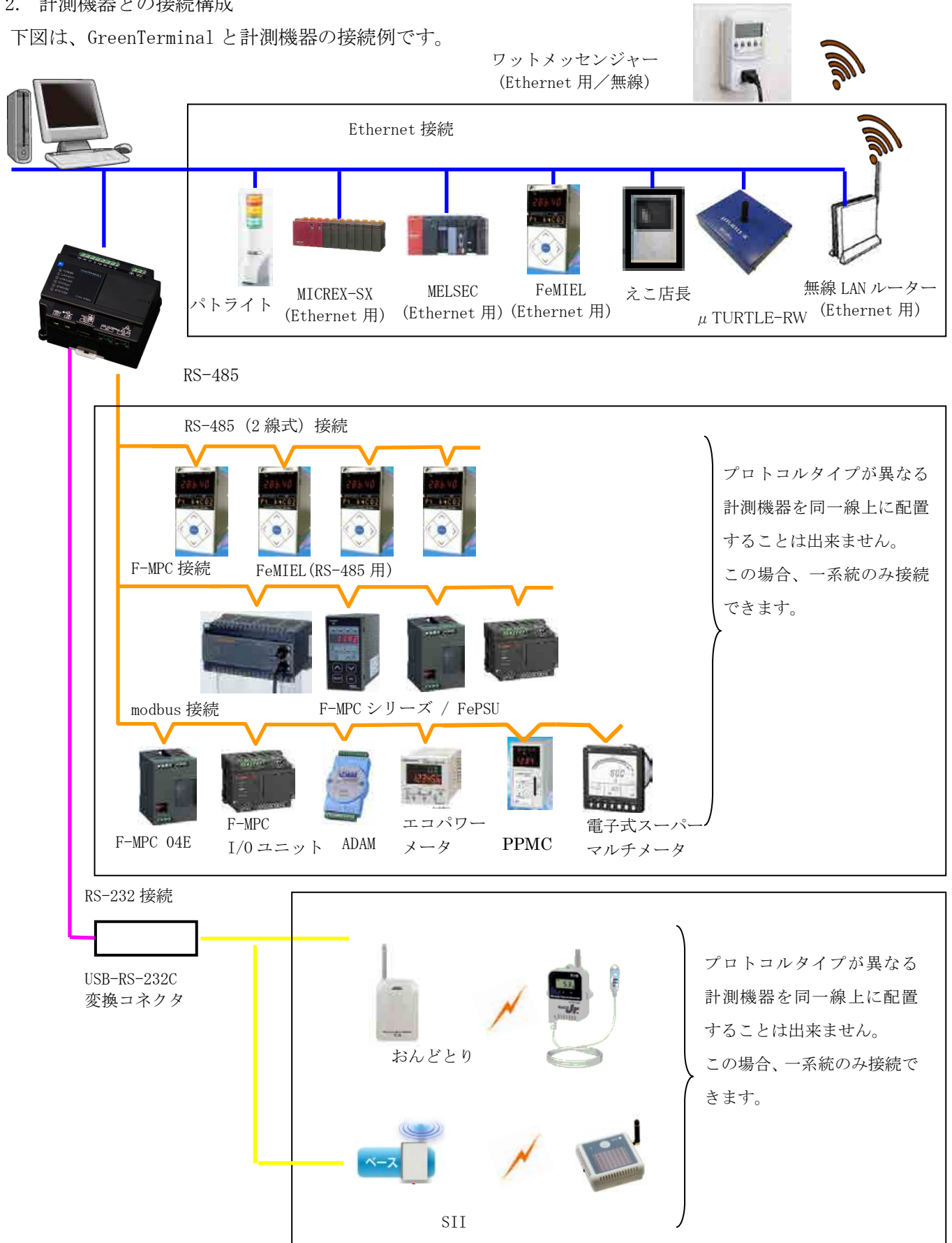
図 5-1 計測機器との接続構成
