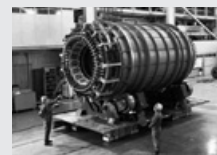
発電機（固定子）
