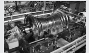
蒸気タービン
