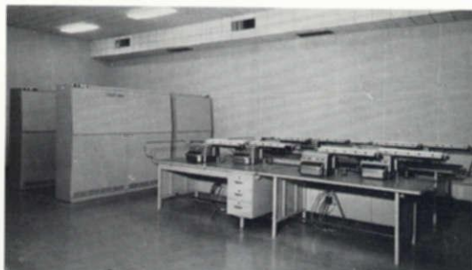
ボイラ、発電機、送風機の監視用データ処理装置（全トランジスタ式）
