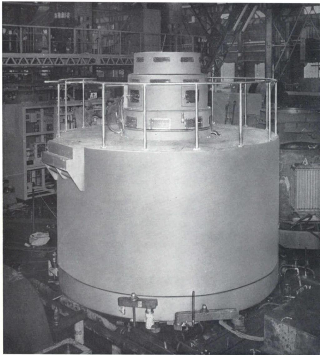
電動機は荏原製作所製の斜流形ポンプと直結されるもので、配水ポンプ用としては、わが国最大である。需要端水圧を一定にするために、回転数を 475~380 rpm の範囲内で自動制御する。この速度制御にシリコン整流器、直流電動機、誘導発電機の組合せによるセルビウス方式を採用している。
