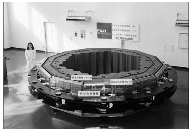
図5 固定反射体の1層組立状態
