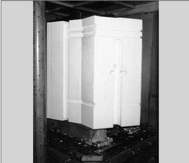
図1 固定反射体ブロックの石こう試作検証
