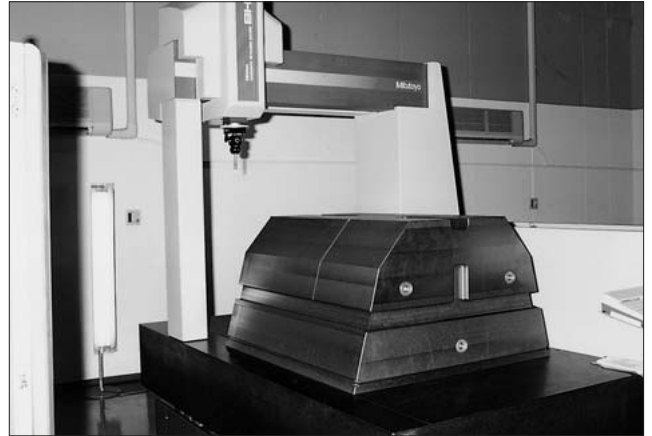
図2 黒鉛構造物の三次元測定
