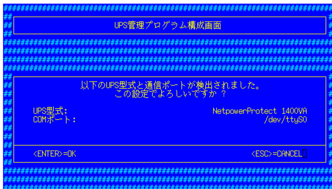
図 3 UPS 型式自動検出結果画面 1
