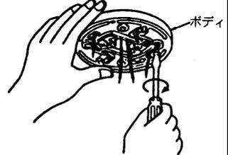
3. 結線完了後カバーを取付けます。
