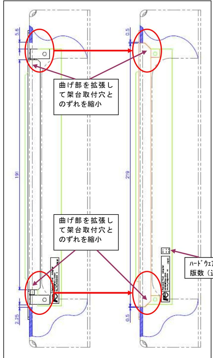
曲げ部を拡張して架台取付穴とのずれを縮小
