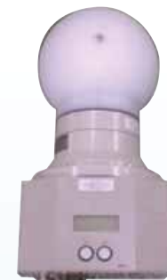
中性子エリアモニタ検出器
