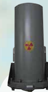
格納容器内 エリアモニタ (電離箱式)
