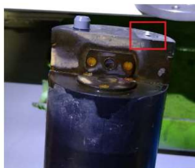
× ピンが破損した濁度センサー (赤枠内)
