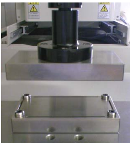
①上治具と下治具をプレス装置にセットする。
