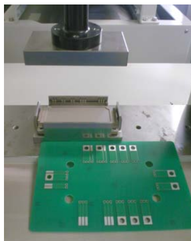
⑤モジュールと PCB は取り外されて 下治具に受け止められる。
