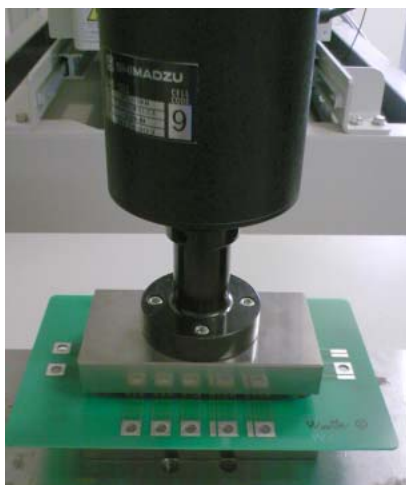
③推奨荷重でモジュールのプレスフィット ピンをプレス装置で押し付ける
