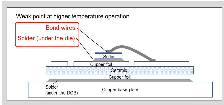
図 1-10 モジュール断面構造図
