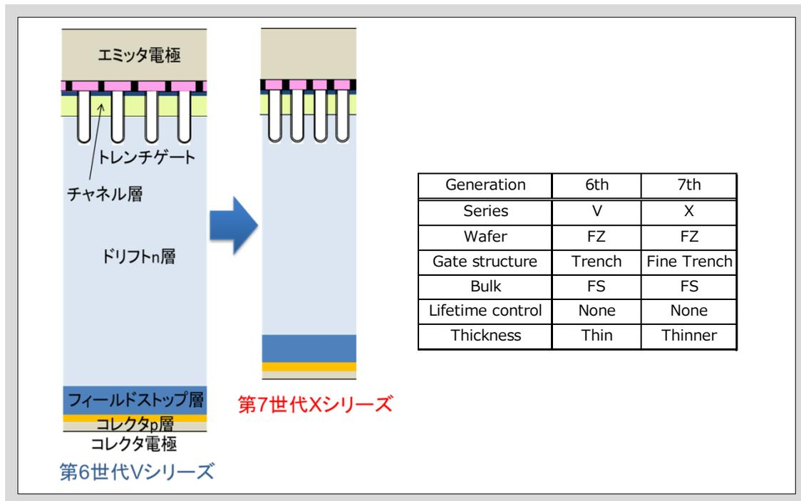
図 1-2 X シリーズ IGBT チップ断面図
