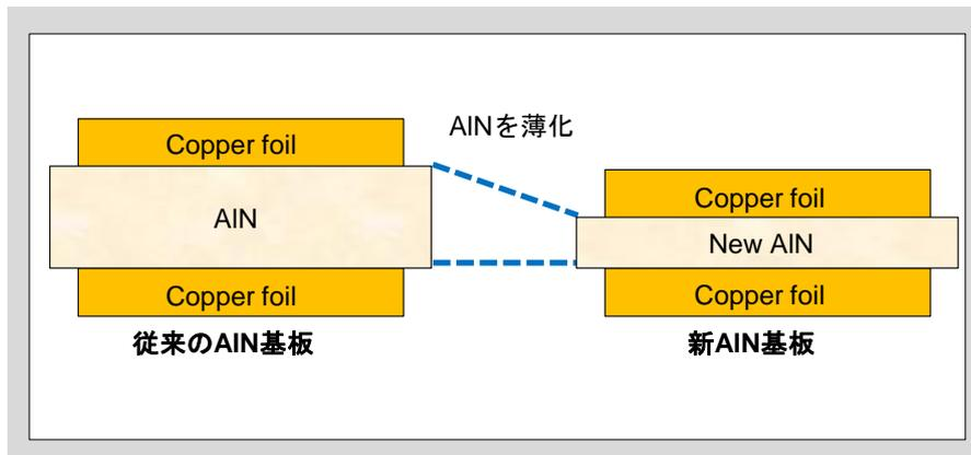
図 1-7 高放熱 AlN 基板の断面構造比較
