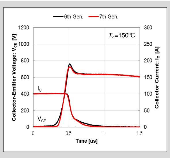
図 1-4 IGBT ターンオフ波形の比較
