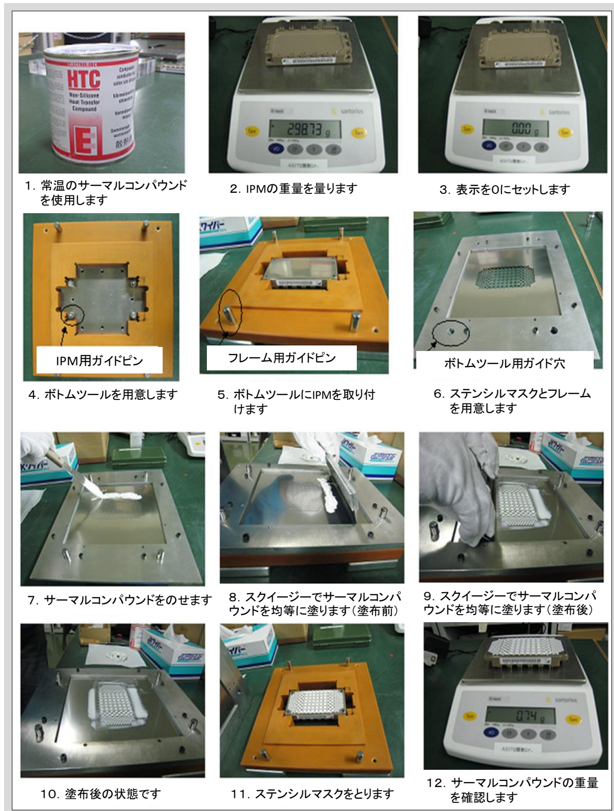
図5-2 サーマルコンパウンド塗布方法例の概略
